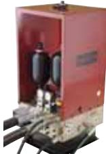
模拟台中使用的测试液压分油站的峰值流量在油压为 210 bar 时达 300 GPM。
