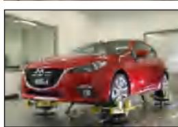
我们的四立柱测试系统配备了专利的静压轴承作动器，以确保低摩擦、高速度和高侧向力承受能力。我们的系统被广泛应用于各大试验室，进行质量评估和振动、噪声和平顺性（NVH）测试。耐久性测试实验室使用这些系统来试验选定的车身、底盘和悬架设计。同时，它们还可用于生产设施异响评估。
