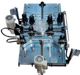
穆格提供定位调整器底座以便针对变化的轮距和轴距来调节作动器位置。穆格既采用自有品牌也采用商业化出售的X-Y轴定位调整器。所提供的选装附件通过减速电机和梯形丝杠进行自动重新调整定位，可快速将作动器调整到需要位置。还提供液压弹簧夹具对移动拖板进行固定或放松。自动控制可通过PC和远程控制选项来实现。
