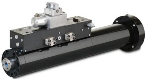
轮胎耦合式道路模拟系统中采用穆格静压轴承作动器。静压轴承可承受更高的横向负荷能力，而不损坏推杆或端部轴承表面。高达300毫米的行程可适应从小型汽车到轻型卡车的广泛汽车应用。
