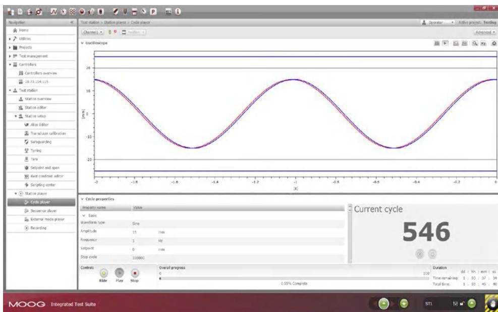
周期播放器将所有必要信息显示一个屏幕上，以控制和监视循环测试。幅值和相位匹配控制可自动调整控制信号以实现目标波形。
