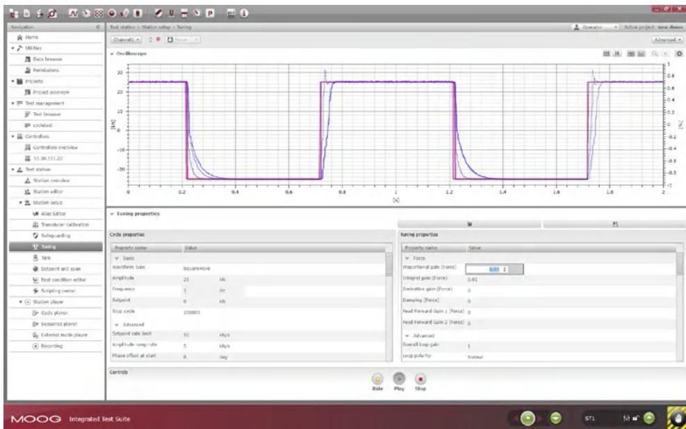
集成测试软件包的调整屏幕允许用户设置命令信号并实时查看对反馈信号的响应。
