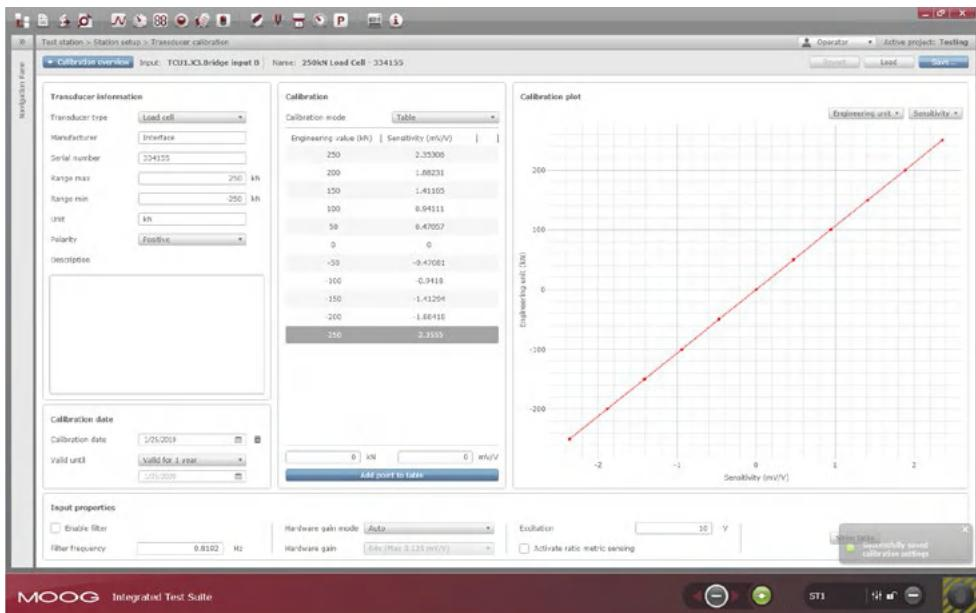
该区域允许用户将传感器信号（电压）转换为所需的工程单位。标定向导以简单的方式指导用户完成整个过程。传感器灵敏度可以直接输入，或通过最多 99 点（用以确保准确的线性度）计算得出。
