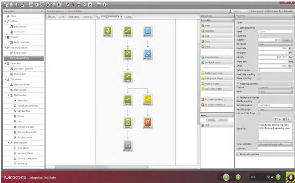
测试模块生成器允许用户快速创建和 / 或编辑测试模块定义。
