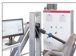
穆格电动多轴测试系统旨在用于设计和生产验证，可高效率用于各种静态或动态测试，座椅系统或四门两盖系统的循环荷载测试。这些电动系统具有低噪音、易安装的特点，并且它们的总运行成本比同等液压系统低。
