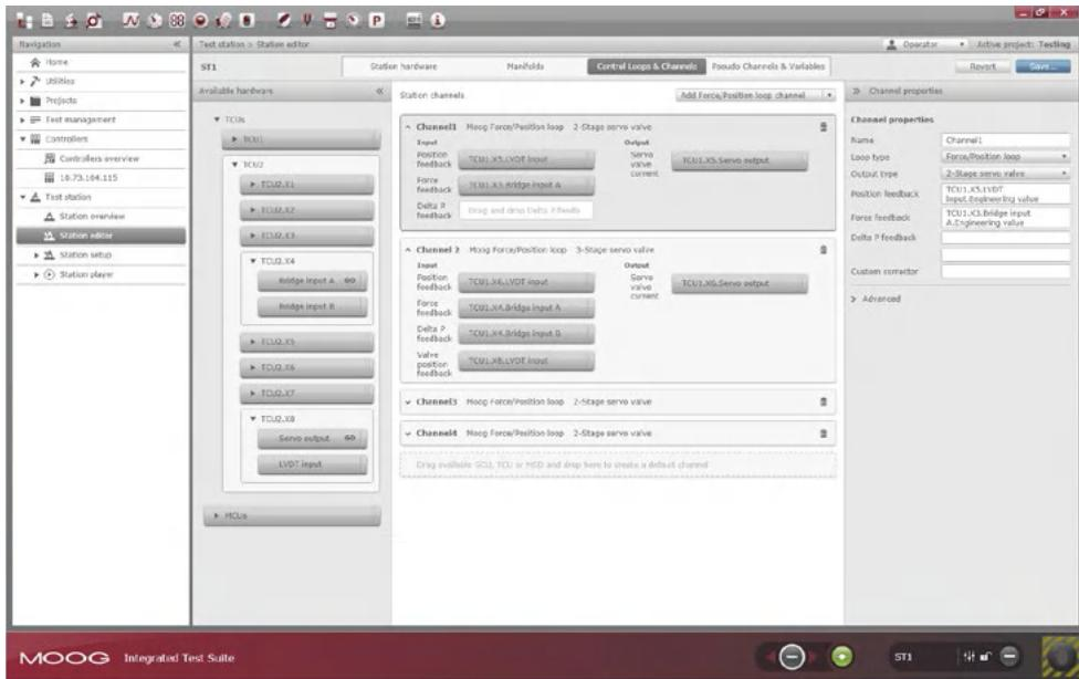
编辑器是配置测试站硬件和软件的主要工具。用户可添加特定的硬件 I/O，创建逻辑通道和所需的控制闭环，还可以添加用于计算的虚拟通道。
