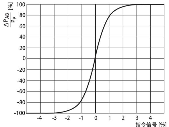
注：在系统压力  $p_p$  为 140 bar (2,000 psi)、液压油粘度为  $32 \text{ mm}^2/\text{s}$  以及油温为  $40^\circ\text{C}$  ( $104^\circ\text{F}$ ) 条件下测得。
