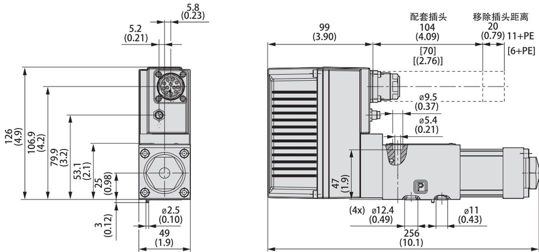
注：带现场总线接口伺服阀的安装图见“电路板电气框架”部分。
