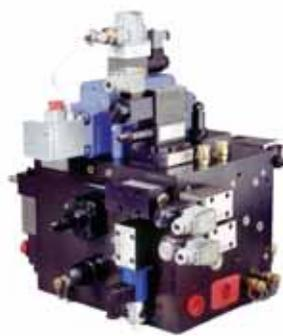
穆格径向柱塞泵满足行业应用要求，具有噪音低、工作寿命长的特点，可在多种严苛环境中提供高性能操作。新型第二代设计（RKP-II）采用新的优化泵壳体设计，使用九个柱塞帮助提高液流输出，降低液压流脉动。RKP-II 因而是现有最安静的长使用寿命泵产品。该泵还可以配备数字板上电子线路以获取精确的压力和流量控制。
