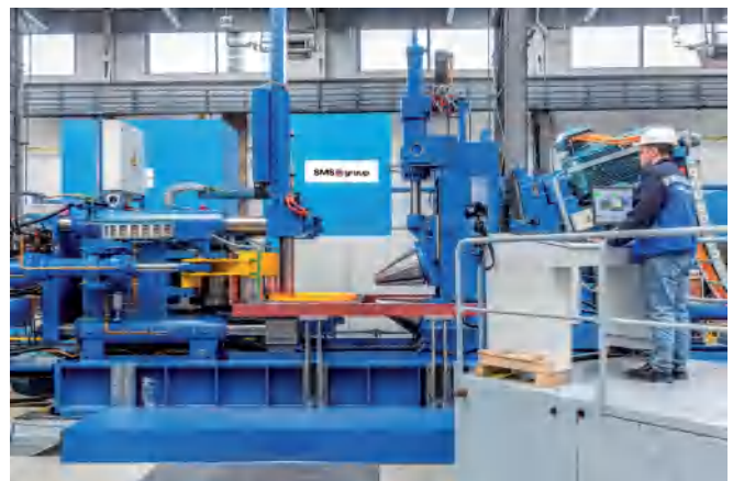
感谢 SMS 集团公司的图片：配有电动伺服泵控系统 (EAS) 的轧环机，用于多个加工运动轴
