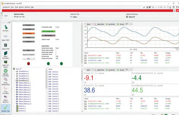
现在测试就已创建完成，按下“运行测试”按钮即准备运行测试。操作屏幕左上方的窗口可以用于连接、启动和运行测试。通过配置右侧图形可以显示指令和反馈，从而让操作者能够监控测试。
