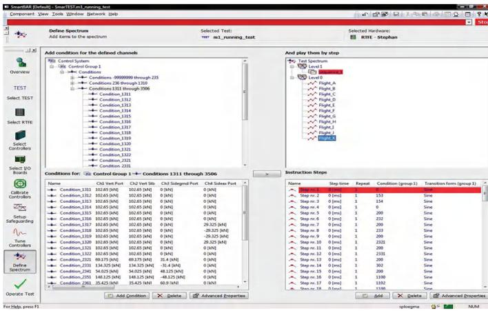
测试设置的最后一步是定义测试范围。按下“定义范围”按钮即可完成这一步骤。在这里，操作者可以详细定制测试配置文件。
