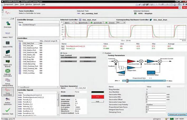
现在，操作者按下“控制器调参”按钮即可以对测试中的各个通道进行调参。可以从左侧窗口中选择通道。依次选择窗口中显示的各个通道及相关调参参数、信号发生器和反馈参数，屏幕会同时显示控制回路的图形视图，以使操作者直观了解控制回路配置。
