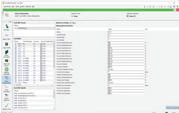
操作者按下“设置安全保护”按钮即可以设置测试的安全极限。右侧窗口中显示对应于左侧窗口中所选通道最常用的通道极限。用户依次选择各个通道即可设置所有通道的安全极限。
