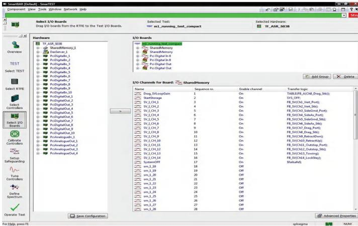
由于穆格测试控制器可以通过一个实时前端同时运行多项测试，因此用户需能够选择测试所需的输入/输出通道。按下“选择输入 / 输出板”按钮，然后拖放输入/输出通道到屏幕右侧的通道窗口即可完成这个选择。
