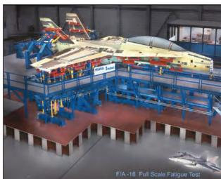
穆格测试控制器拥有安全运行大型静态测试所需的特性、安全性和通道数，最高可达到 500 个通道。
