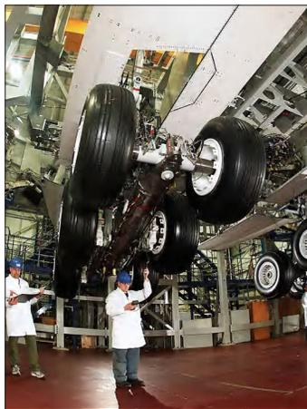
穆格测试控制器和航空航天测试软件包是您的测试台架所需的必要工具，能够连接您的测试台架对许多部件应用 (包括起落架、飞行控制装置和机身构件) 进行测试。
