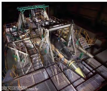
穆格测试控制器和软件通过简单的范围定义不仅能够运行大型静态测试，而且能够安全、高效地控制长期疲劳测试。
