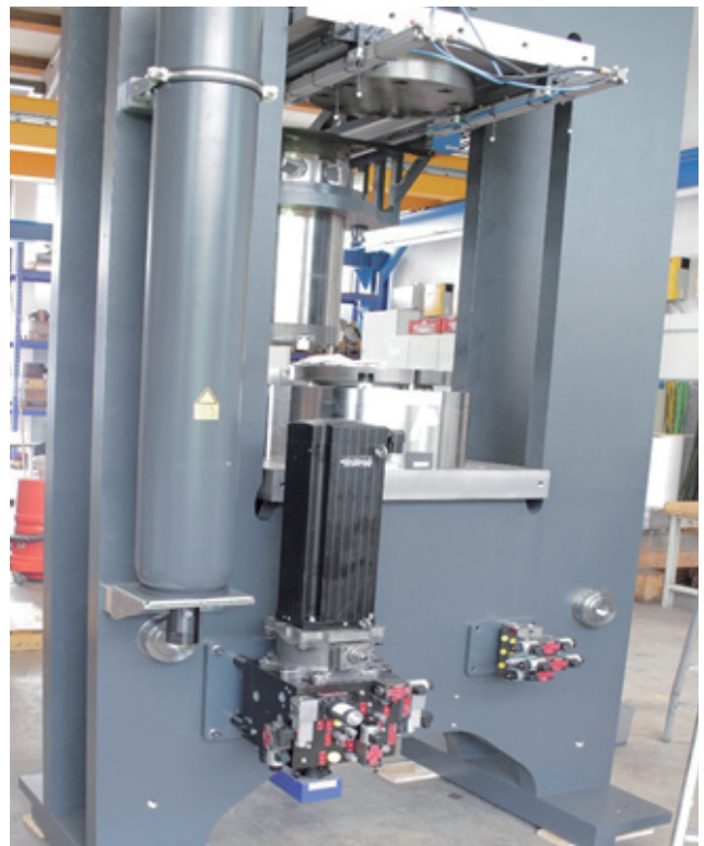
采用穆格电动伺服泵控系统的 Frey EasyISO 陶瓷压机 (照片由 Frey and Co. 公司提供)
