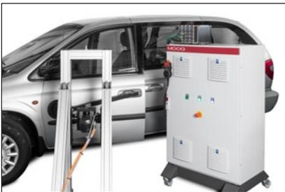
关门测试是衡量车辆耐久性和质量的一个重要部分。对于经常暴露在热，冷或者潮湿环境中的引擎罩、门、滑动门、后挡板、行李箱盖和其他需要周期耐久性测试的部件，电动多轴测试系统可以提供精确且可重复定位的速度和驱动力开闭试验并进行记录，保证您的测试结果可靠与准确。
