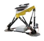
载人级别的电动模拟台搭配了占地面积 小的Stewart平台结构,包含若干电动 作动器,从而可以实现六个自由度运 动。测试控制器可向模拟台输入振动谱 或时间历程数据,以对舒适度评估进行 精确控制。
