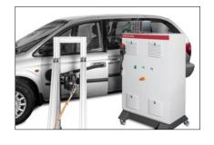
关门测试是衡量车辆耐久性和质量的一个重要部分。对于经常曝露在热,冷或者潮湿环境中的引擎罩、门、滑动门、后挡板、行李箱盖和其他需要周期耐久性测试的部件,电动多轴测试系统可以提供精确且可重复定位的速度和驱动力开闭试验并进行记录,保证您的测试结果可靠与准确。
