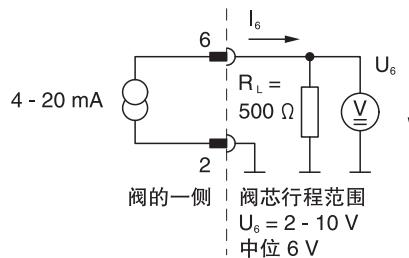
(信号类型为“D”,  $R_L$  集成在电路板上)
