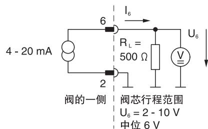
(信号类型为 “D”,  $R_L$  集成在阀用电路板上)
