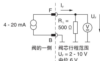
(信号类型为“D”,  $R_L$  集成在电路板上)
