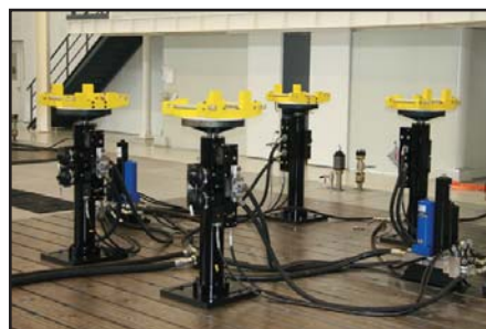
4 立柱静压测试系统
