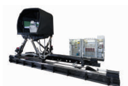
配备侧向导轨的7自由度驾驶模拟器
