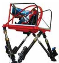
我们的六杆并联设计实现了“人在回路”测试以及主要适驾特性反馈，包括涉及人体工程学课题的座位舒适度。最近的应用包括虚拟轮胎和悬挂系统设计的人类评估。
