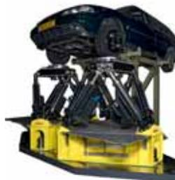
我们的六自由度运动性与平顺性测量系统是与一家汽车制造商联合开发的，通过力或位移控制准确测量刚度和运动性。我们革命性的六杆并联技术和电动作动系统安装简便、占地面积小、维护成本低。而且实际上，我们是唯一在汽车运动性与平顺性测试中采用电动六杆并联设计的公司。
