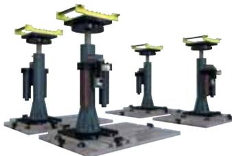
我们的四立柱道路模拟器基于配有静压轴承的液压测试作动器，广泛应用于各种测试，包括在研究实验室用于进行驾乘品质评估和噪音、振动和舒适性 (NVH) 测试；以及用于耐久性测试实验室验证所选结构、底盘和悬架系统的设计。同时还用于生产车间进行汽车噪音测试评估。整个系统采用疲劳级伺服作动器，提供所需的垂直加速度，并能够承受多数汽车测试中产生的侧向载荷。
