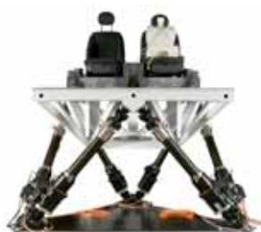
载人级电动模拟平台由六个电动作动器提供所需的 6 自由度上的加速运动。六杆并联设计占地积极小。此外，测试控制器可执行控制文件，提供精确级别的控制和操作，从而使数字数据更接近人类感觉。
