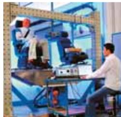
穆格的测试台架专门设计用于获取关键分析并提供极大的测试灵活性，可在多种单轴和多轴应用中高效运行，其中包括耐久性测试、振动测试、冲击与性能评估等。所有设备均可进行调节以承接各种测试样品。
