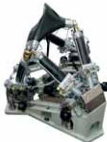
用于产生和测量力，以模拟和测试汽车悬挂系统的实时疲劳度，包括考虑汽车最大动态特性和形成不同的测试载荷。
