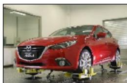
我们的四立柱测试系统配备了专利的静压轴承作动器，以确保低摩擦、高速度和高侧向力承受能力。我们的系统被广泛应用于各大试验室，进行质量评估和振动、噪声和平顺性（NVH）测试。耐久性测试实验室使用这些系统来试验选定的车身、底盘和悬架设计。同时，它们还可用于生产设施异响评估。
