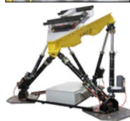
液压模拟平台提供加速度或位移输入以复现在试验场地收集的时间历程数据。试样通常包括车身部件和系统，如电池包、发动机悬置、散热器和驾驶室等。
